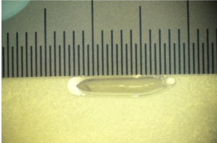
図 3 : 1 マイクログラムの BCR-1 が封入された合成石英管
