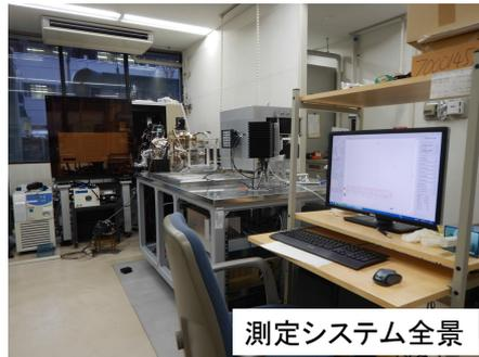
図2 産業技術総合研究所における<sup>40</sup>Ar/<sup>39</sup>Ar年代測定システム
