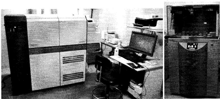
図16 a ホットラボに設置されている分析機器類(1) ICP-MS と蛍光 X 線分析装置
