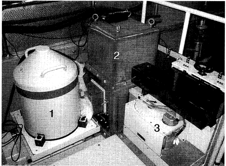
図 1 JRR-4 即発 \gamma 線分析装置. 1:Ge 検出器液体窒素デュワ. 2:試料箱とビームストップ. 3:自動試料交換機.
